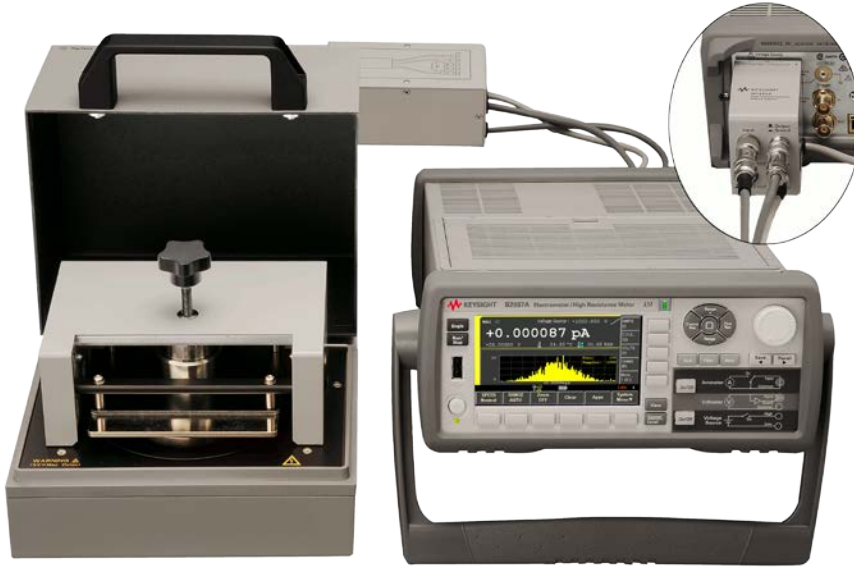
圖 11：Keysight B2980A 和 16008B 的配置範例，以執行電阻率量測
