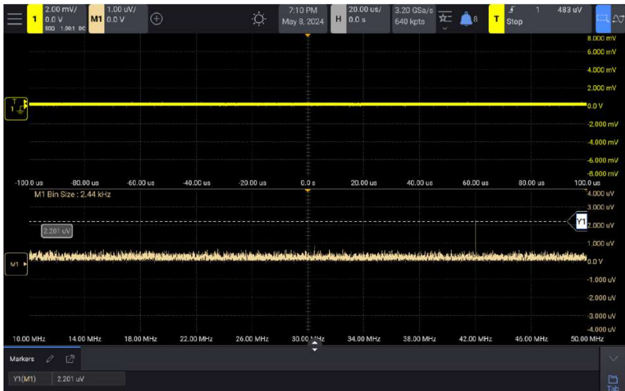
圖 1：在 FFT 模式中，此示波器可非常清楚地擷取到 2 uV、-100 dBm 的信號。相較之下，其他本底雜訊較高的示波器，則無法呈現這些微小信號。
