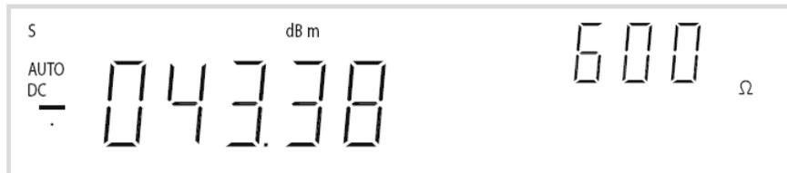
圖 2-1 典型的 dBm 運算顯示器
