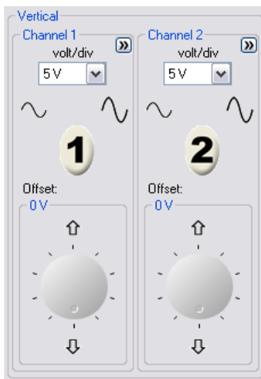
圖 2-1 軟體前端面板垂直系統控制項
