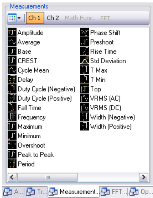
圖 2-8 「Measurements & Cursors」面板上的自動量測
